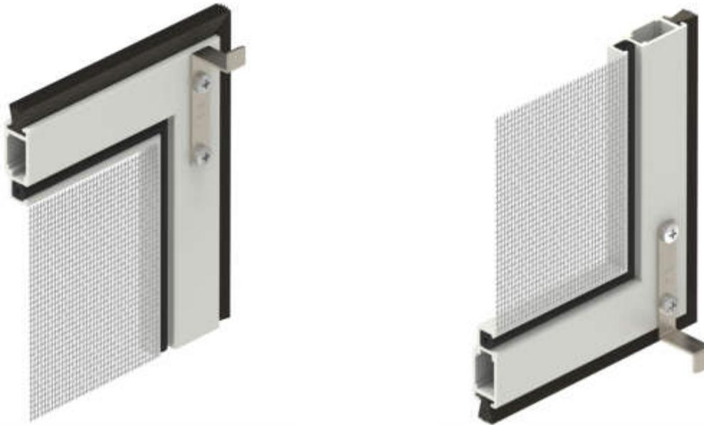
Der Spannrahmen wird in den Flächenversatz zwischen Fensterflügel und Blendrahmen durch eine umlaufende Bürstendichtung hineingeklemmt. Ein Herausfallen nach außen wird durch angeschraubte Anschlagwinkel verhindert. Beachten Sie, dass für einen optimalen Halt eine leichte Fasse der Blendrahmenkontur nach außen erforderlich ist.
