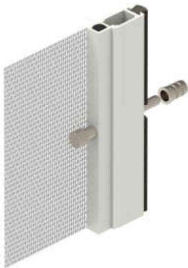
Mittels am Spannrahmen angebrachter Federstifte (im Standard 4 Stk. Art.Nr.B1540 + B1690) wird das Element am Blendrahmen oder in der Rolloführungsschiene durch zuvor eingebrachte Einschlaglöcher befestigt.
